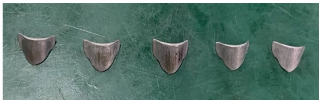
图 11 片状阴极连续加工产生的楔形块
